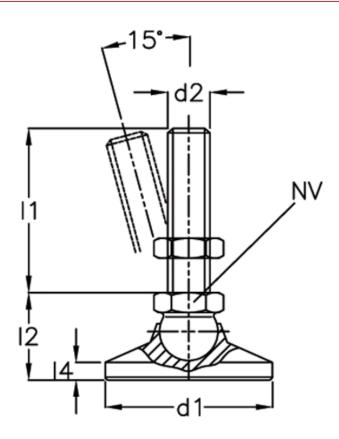
d1 = 40 Static load = 23 d2 = M10 Weight in (g) = 172 l1 = 80
